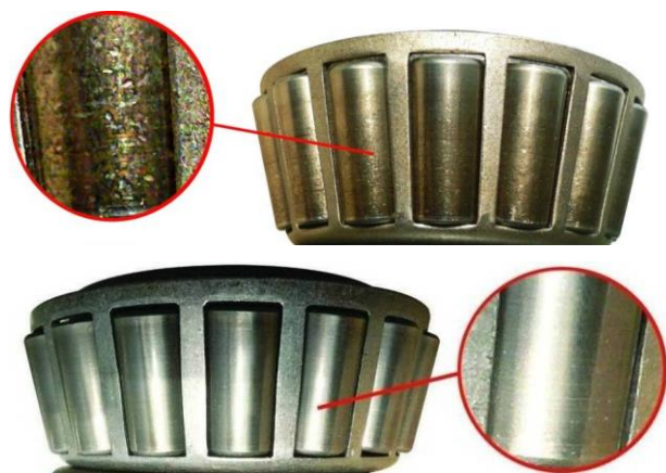
Рис. 3. Зношування підшипників кочення: вгорі підшипник після 1000 годин експлуатації, внизу з використанням нанопорошку Al_2O_3 після 6000 годин
