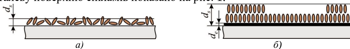
Рис. 1. Зміна товщини граничного шару мастила d_s : (а) – без нанесення на поверхню шару епіламу; (б) – з нанесенням на поверхню шару епіламу
