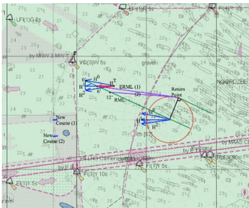
Рис. 5.7. Розрахунок маневру розходження в ситуації обгону судна з лівого борту
