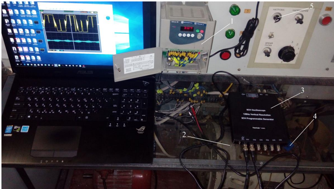
Рис. 4.15 Зовнішній вигляд лабораторної установки: 1 – ЧП; 2 – двохобмотковий АД; 3 – осцилограф; 4 – датчик струму; 5 – регулювання струму навантаження.
