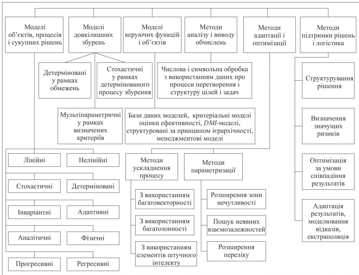
Рис. 6.2 Структура СППР при проектуванні та дослідженні СЕУ КПК
