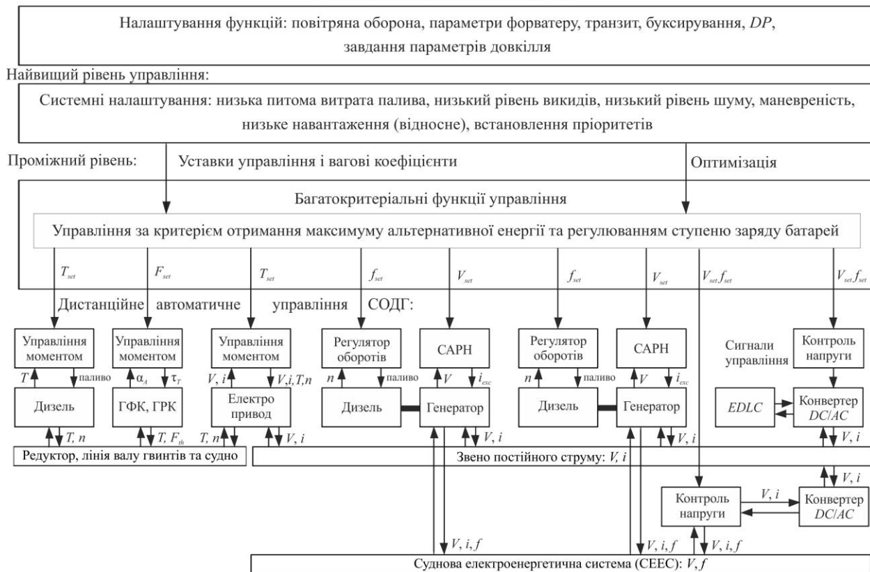
Рис. 5.3 Блок-схема стратегії управління СЕУ КПК за критерієм максимуму альтернативної енергії та регулювання ступеню заряду батарей CHE: CAPN – система автоматичного регулювання напруги (англ. Automatic Voltage Regulator – AVR ); X_{set} – уставка; T – упор (момент); F – сила поштовху гвинта; f – частота напруги; V – напруга; n – частота обертання СОДГ; i_{exc} – струм збудження генераторів; i – струм; \tau_T – результуюча проекції вектору зусилля на площину руху судна; \alpha_A – кут повороту ПП відносно діаметральної площини судна
