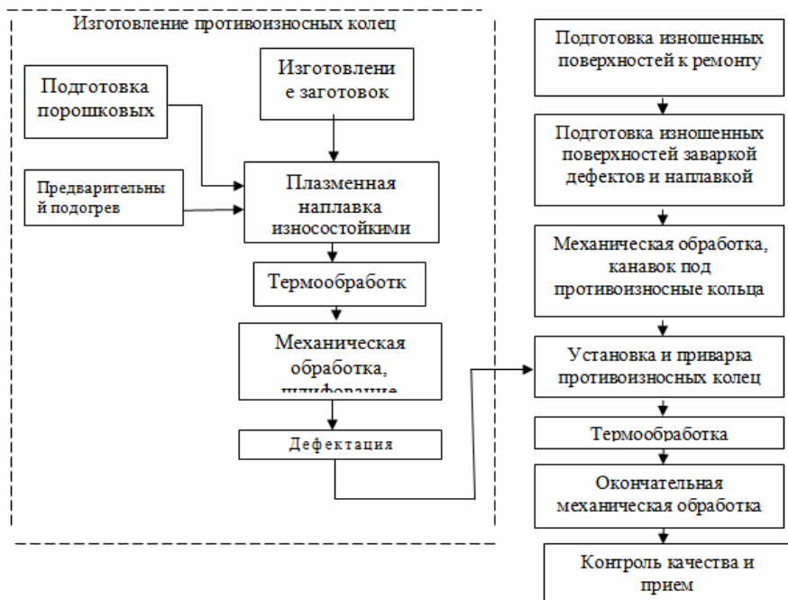
Рис. 4. Технологическая схема ремонта головок поршней МОД плазменной наплавкой.
