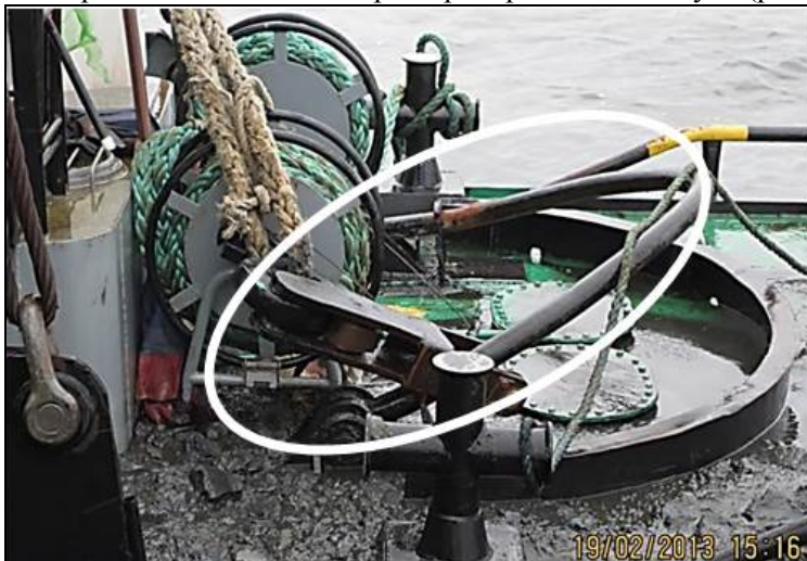
Рис.6. Буксирный гак и буксирный трос на левом борту, деформированная буксирная дуга.
