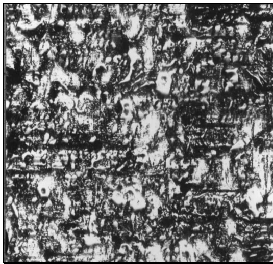
Рис. 2. Микроструктура наплавленного плазменным методом слоя «Т- Термо» × 200
