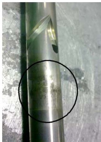
Рис. 2. Характерный износ плунжера ТНВД вследствие попадания в топливо примесей воды
