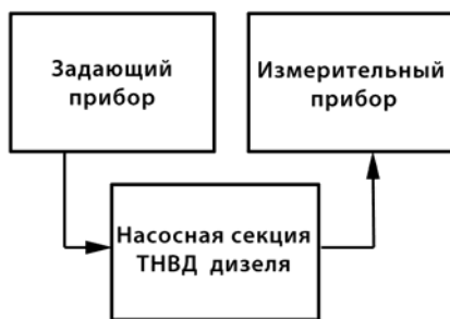
Рис. 1. Блок-схема прибора "ЭПСИЛОН – М"
