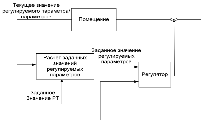
Рис. 6. Схема с предварительным расчетом заданных значений регулируемого параметра
