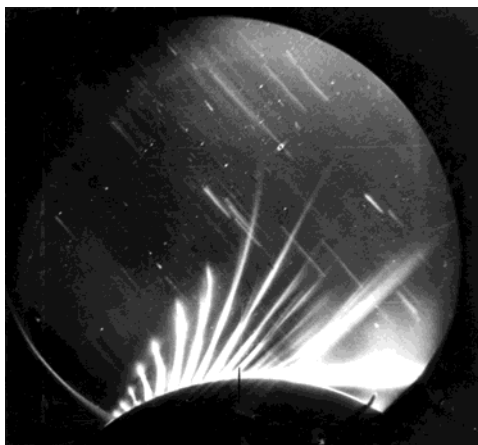
Рис. 2. Визуализация течения в области "горла" канала
