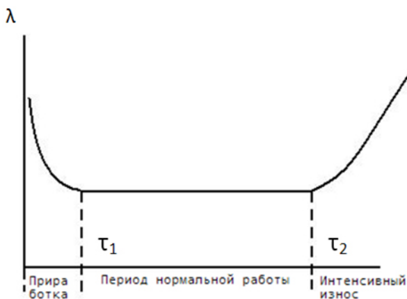
Рис. 1. Изменение интенсивности отказов в зависимости от наработки на отказ в процессе эксплуатации
