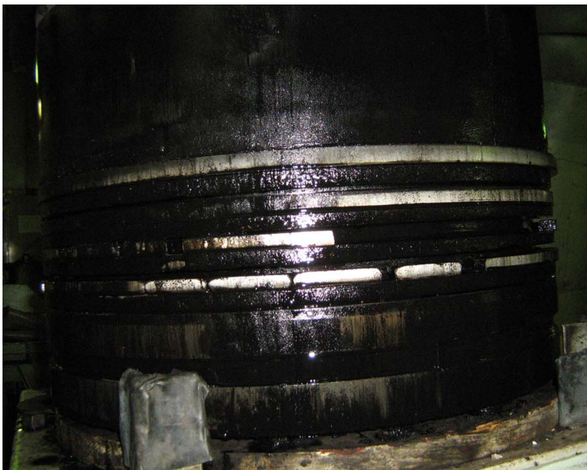
Рис. 3. Поршень двигателя SULZER 7RTA-62U с поломанными 3-м и 4-м кольцами
