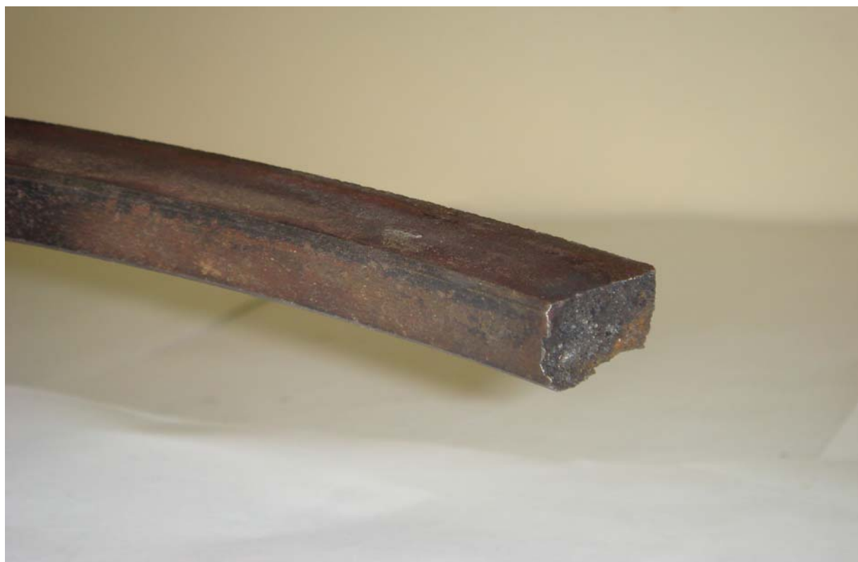
Рис. 4. Фрагмент поломанного уплотнительного кольца двигателя SULZER 7RTA-62U
