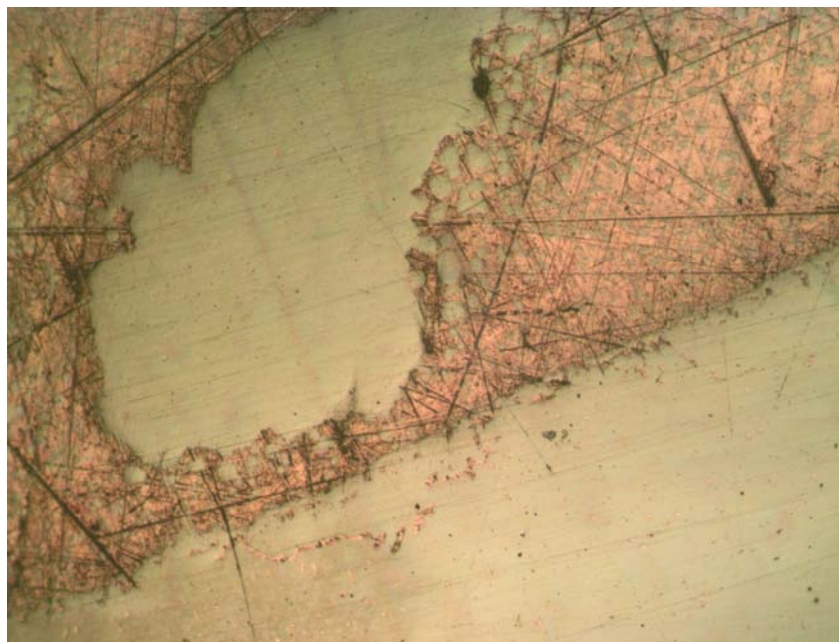
Рис. 8. Нетравленный микрошлиф. Механическая смесь железного и медного сплавов, возникающая при наплавке, \times 450
