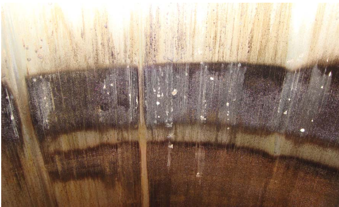
Рис. 6. Зеркало втулки с участками графитизации и следами схватывания и вырывания участков поверхностного слоя материала втулки
