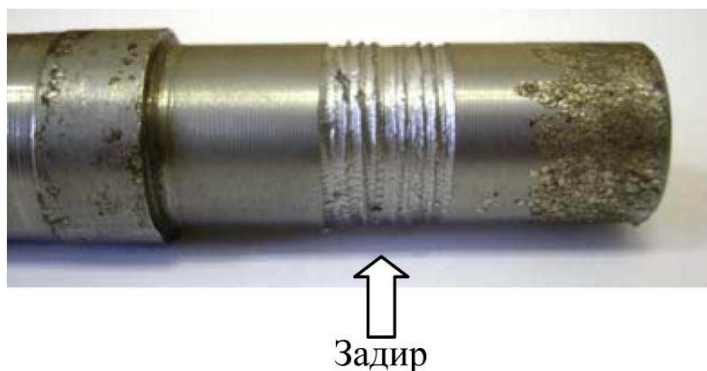
Рис. 4. Имитация задира на валу
