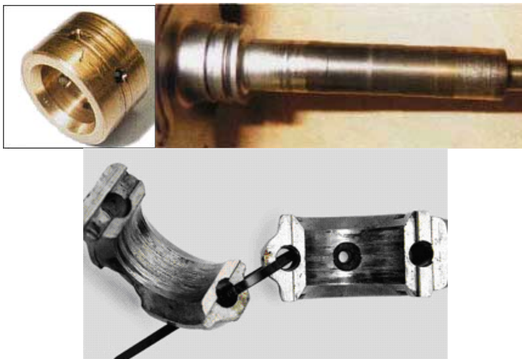
Рис. 1. Примеры поверхностей с задирами
