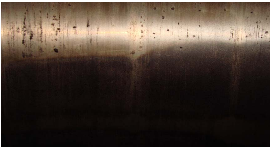
Рис. 5. Графитизация рабочей втулки цилиндра выше продувочных окон, на которых был нарушен режим смазывания
