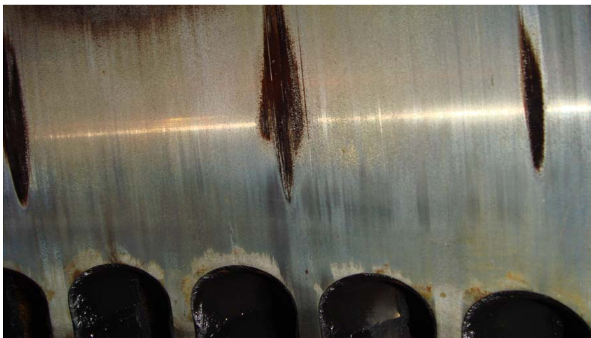
Рис. 7. Схватывание второго рода на зеркале втулки цилиндра SULZER 7RTA-62U.
