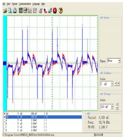
Рис. 9. Параллельная работа ДГ 1 и ДГ 2, 550 А и 500 А, работа гребных двигателей, красная кривая — ток ДГ 1, синяя — ток ГД 2
