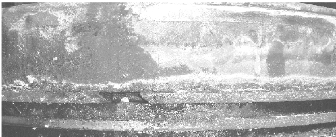
Рис. 2. Нагароотложения в районе поршневых колец
