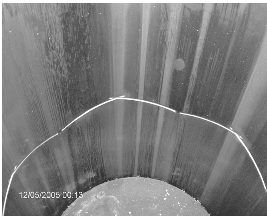
Рис. 7. Характерные натирсы на зеркале цилиндрической втулки
